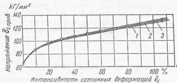
Рис. 3. Кривые пластического деформирования стали 30ХГСА при линейном учете влияния величины шаровой части тензора. 1 — линейное сжатие; 2 — линейное растяжение и стесненное сжатие; 3 — двухосное сжатие и трехосное сжатие. \bar{\sigma}_i \text{ прив} = \bar{\sigma}_i + A \bar{\sigma}_{ш} , A = +0,0377
