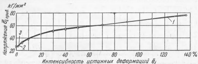
Рис. 4. Кривые пластического деформирования технически чистого железа при линейном учете влияния величины шарового тензора. 1 — все пять кривых (линейное растяжение, линейное сжатие, стесненное сжатие, двухосное сжатие, трехосное сжатие) совпали в одну; 2 — линейное растяжение и линейное сжатие; 3 — стесненное сжатие, двухосное сжатие и трехосное сжатие. \bar{\sigma}_i \text{ прив} = \bar{\sigma}_i + A\bar{\sigma} = +0,0393
