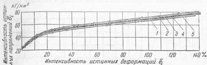
Рис. 2. Кривые пластического деформирования технического чистого железа (термическая обработка — отжиг). Обозначения кривых те же, что на рис. 1
