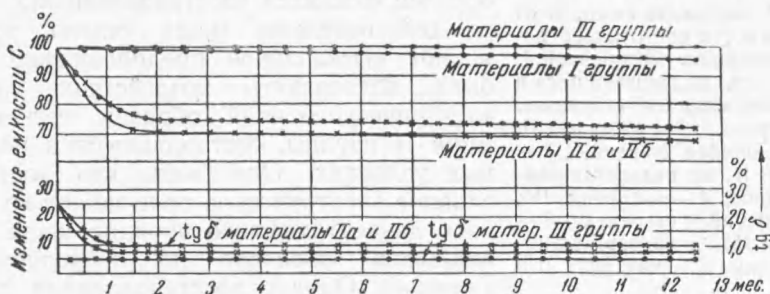
Рис. 1. Изменение емкости и \operatorname{tg} \delta конденсаторов из сегнетокерамики в зависимости от времени выдержки их при t = 20^\circ
