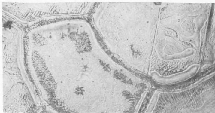
Рис. 4. А — микрофотография поверхности образца стали ЭИ-395, выявленная при нагреве в вакууме. В данном участке температура составляет 1150-1180^{\circ} (стрелкой показано направление зоны более высоких температур). Выдержка 10 мин., \times 300 . Б — микрофотография поверхности образца стали ЭИ-395, выявленная за счет избирательного испарения при нагреве в вакууме. Температура нагрева 1200^{\circ} . Выдержка 10 мин., \times 300
