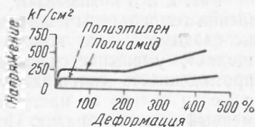
Рис. 1. Зависимость напряжения от деформации для полиамида и полиэтилена при 20^{\circ}
