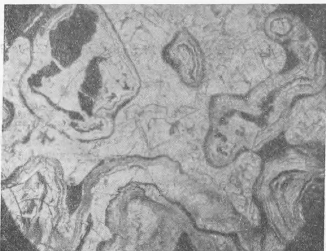
Рис. 1. Колломорфная структура гиббситового боксита. Черная, нераскристаллизованная масса. Проходящий свет; \times 100 ; николи ||
