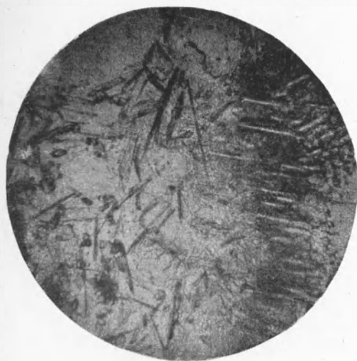
Рис. 1. Общий вид контактного слоя на границе шамота с многокальевым стеклом. \times 80
