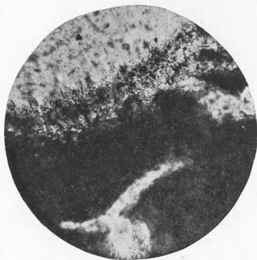
Рис. 2. Контактный слой на границе шамота со стеклом, докристаллизованный кристаллитом. \times 200
