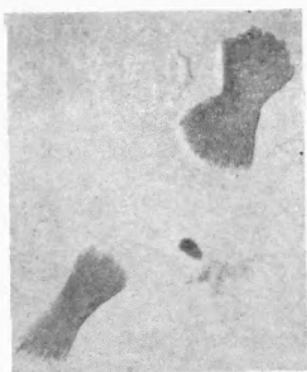
Рис. 3. Продольное расщепление коротких сегментов сваренной дисперсии. Электронная микрофотография. × 12 000
