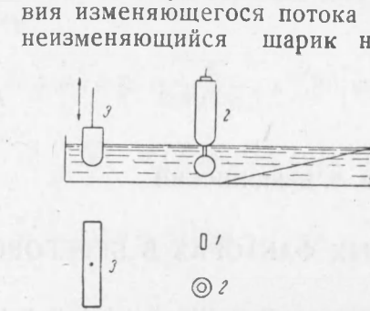
Рис. 2. Схема размещения приборов при опытах в лотке. 1 — электрический волнограф со спиралькой, регистрирующий волны на поверхности; 2 — прибор ВДК; 3 — волнопродуктор
