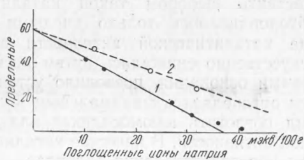
Рис. 1. Степень превращения циклогексена на промышленном синтетическом алюмосиликате, отравленном ионами натрия. 1 — прямая зависимости для образцов, обработанных растворами солей натрия; 2 — то же для образцов, обработанных растворами щелочи
