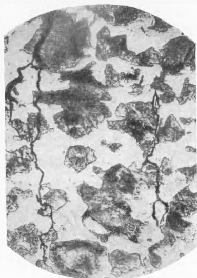
Рис. 3. Микротрещины коррозионной усталости. Сталь 20Х (перлит-феррит). a — устье трещины, \times 134 , N=37 \cdot 10^6 ; б — средняя часть трещины, \times 134 , N=37 \cdot 10^6 ; в — трещина, \times 313 , N=10^8 ; г — конец трещины, \times 313 , N=10^8
