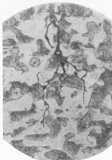
Рис. 3. Микротрещины коррозионной усталости. Сталь 20Х (перлит-феррит). a — устье трещины, \times 134 , N=37 \cdot 10^6 ; б — средняя часть трещины, \times 134 , N=37 \cdot 10^6 ; в — трещина, \times 313 , N=10^8 ; г — конец трещины, \times 313 , N=10^8
