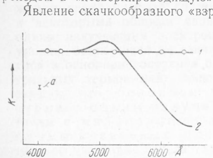
Рис. 4. Коэффициент пропускания (при 4,2° К) образца висмута, осажденного при 2° К (1) и затем отогретого до 45° К (2); a — ошибка в измерении
