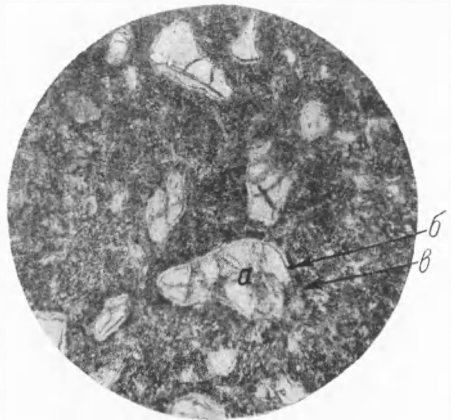
Рис. 2. То же, что на рис. 1, с добавкой FeO 7,50%, Al 2 O 3 2,50%. a — трещиноватые зерна кварца; б — светлые каемки из метастабильного внешне бесструктурного кристобалита; в — прерывистые темные каемки стекловидного вещества. \times 80 . Николи \perp
