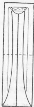
Рис. 1. Простая камера для бумажной хроматографии. Герметическое пространство создается при помощи двух вегетационных сосудов, соединяющихся открытыми частями. Место соединения сосудов замазывается пластилином. Внутри камеры находится металлический треножник, на котором установлена фарфоровая чашка с растворителем. В нее погружены концы подготовленных для хроматографирования полос фильтровальной бумаги. Свободные концы полос бумаги свисают
