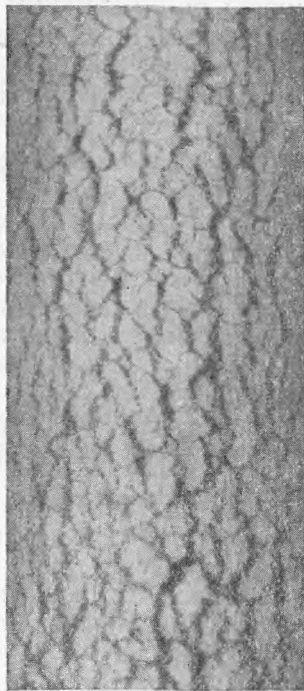
Рис. 1. Растрескивание наклеенной смоченной бумаги на резиновой трубке при ее расширении
