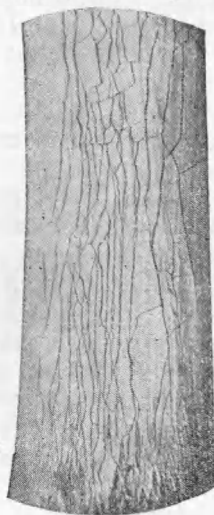
Рис. 2. Растрескивание нанесенного слоя мела на резиновой трубке при ее расширении
