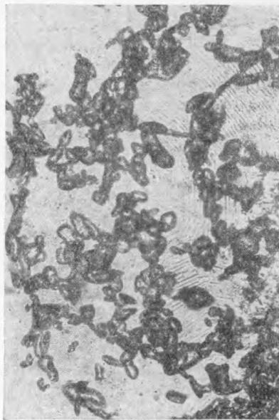
Рис. 3. Деталь снимка рис. 2 при большем увеличении. Без анализатора, \times 250 . Репрод. 4:5
