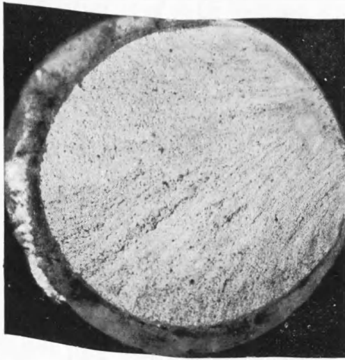
Рис. 4. Внешний вид изломов стали 40ХНМА с отпуском 200: a — излом образца при чистом растяжении, б — излом образца при растяжении после кручения до деформации 35% г , в — излом двойного образца при растяжении после предельного кручения
