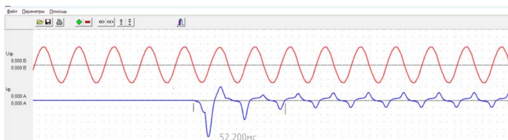
Рис. 4. Регистрограмма напряжения и тока при включении микроволновой печи «LG MS2021U», ras00472.dat
