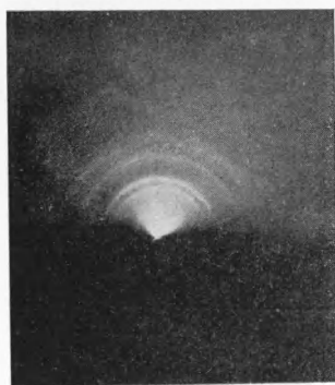
Рис. 4. Электронограмма стали с 1,18% С, ванадия при 1000^{\circ} 6 час.
