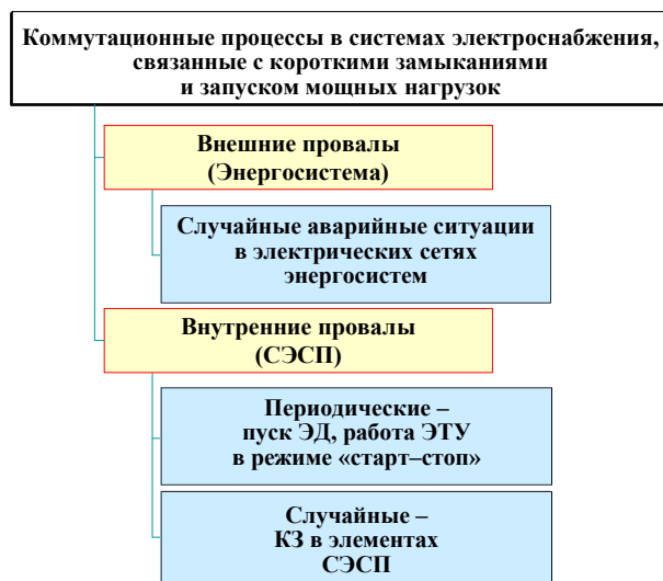
Рис. 1. Классификация провалов напряжения по источникам возникновения и закономерности появления
