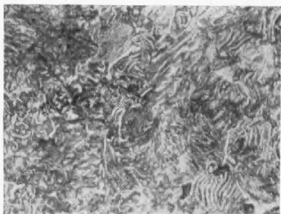
Рис. 1. Микроструктура отожженной никелевой стали опытной плавки. \times 400 . Репрод. 3:4
