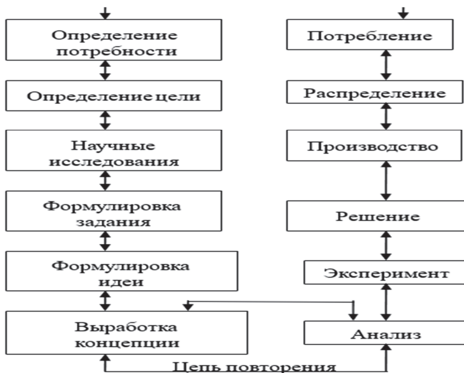
Рис. 1 – Обобщённая схема инвариантности в проектировании гидроблоков управления технологического оборудования
