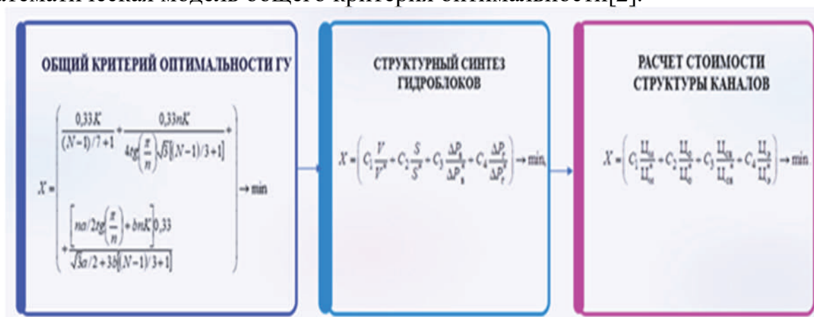
Рис. 2 – Модель расчета функциональных показателей ГУ приводов ТО при их проектировании
