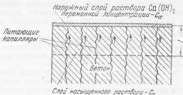
Рис. 2. Схема диффузионного процесса выщелачивания извести из бетона
