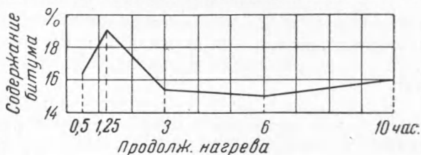
Рис. 2. Зависимость образования битума от продолжительности нагрева
