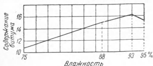
Рис. 3. Влияние влажности торфа на выход битума
