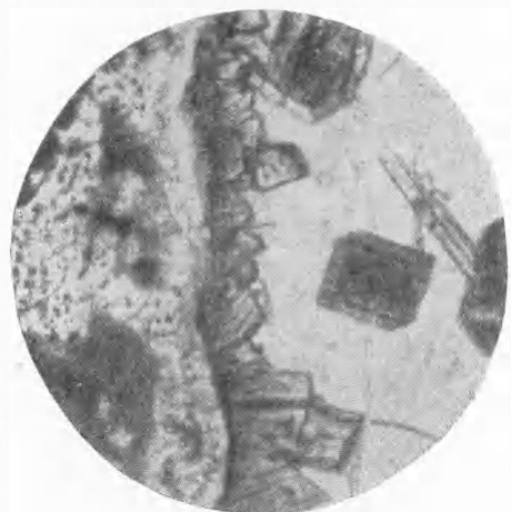
Рис. 2. Корочка нарастания мелких кристалликов эгирина и др. на известняке. \times 200 . Без анализатора
