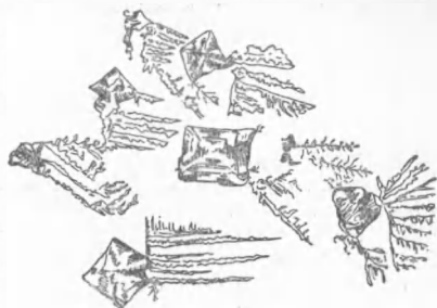
Рис. 3. Одна из стадий обратного перехода дендритной формы \text{KCl} , образовавшейся в присутствии агар-агара, в кубическую под действием примеси \text{Fe}^{3+}
