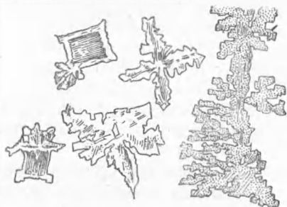
Рис. 2. Преимущественный рост вершин кристалла \text{KCl} и образование дендрита в присутствии глицерина
