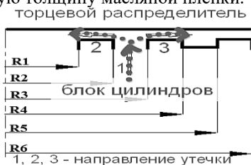
Рисунок 1 – Расход утечки в зазоре между торцевым распределителем и блоком цилиндров
