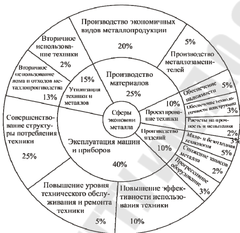
Рис. 7.2. Распределение источников возможной экономии металла
