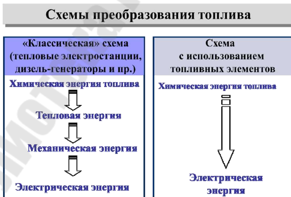
Рис. 2.5. Схемы преобразования топлива
