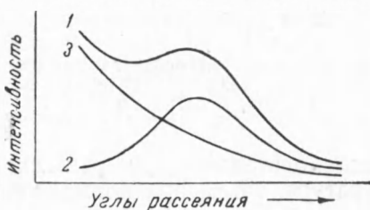
Рис. 1. Схема углового распределения интенсивности рассеяния рентгеновских лучей в аморфных полимерах. 1 — рассеяние в полимерах, 2 — рассеяние в жидкостях, 3 — рассеяние в газах
