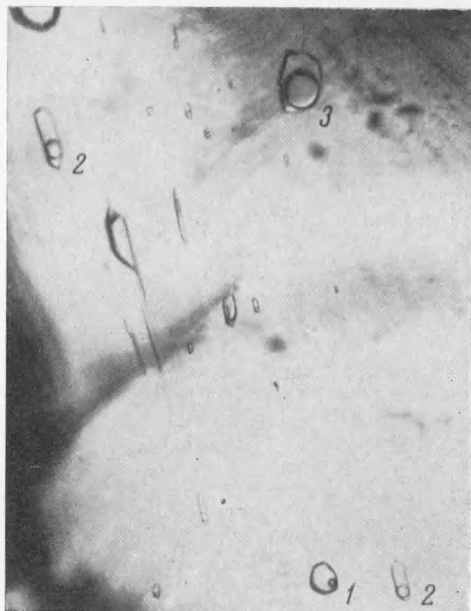
Рис. 1. Общий вид и расположение включений в кварце при комнатной температуре. Снято в проходящем свете. \times 100
