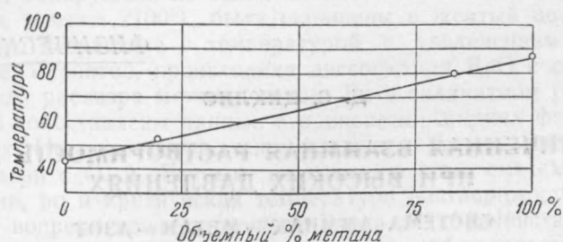
Рис. 3. Зависимость температуры двойной гомогенной точки от содержания метана в смеси, освобожденной от аммиака
