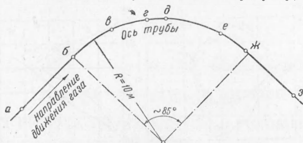
Рис. 3. Развитие поперечных и продольных перемещений трубы ( d=300 мм, \delta=11 мм, H=1,7 м) на горизонтальном ее повороте под углом 85^\circ (радиус поворота оси трубы 10 м) при повышении давления газа на 40 атм.
