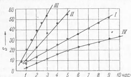
Рис. 1. Скорость полимеризации стирола при 85° в присутствии: I — (\text{CH}_3)_3\text{COOH} ; II — \text{C}_6\text{H}_5(\text{CH}_2)_2\text{COOH} ; III — (\text{C}_6\text{H}_5)_2\text{CH}_2\text{COOH} ; IV — (\text{C}_6\text{H}_5)_3\text{COOH} при концентрации 0,0566 М/л
