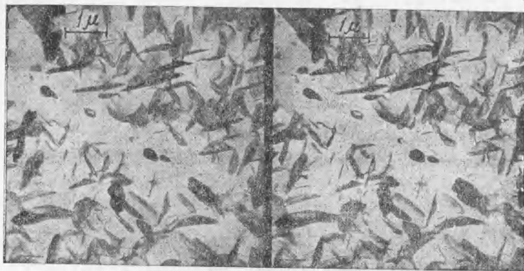
Рис. 3. Сплав Al—Ag. Искусственное старение. 300°, 1 час, глубокое травление
