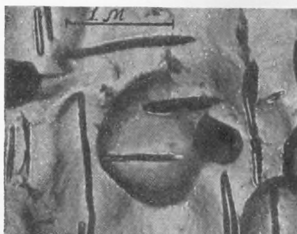
Рис. 2. Искусственное старение сплава Al — Si: a — 150° — 12 ч., глубокое травление; б — 150° — 48 ч., глубокое травление; в — 350° — 2,5 ч., глубокое травление
