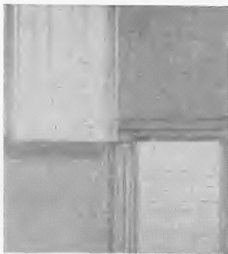
Рис. 3. Общий вид механического двойника в кристалле сегнетовой соли. Николи скрещены. \times 20 . Репрод. 4:5
