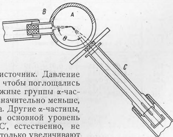
Рис. 1. Схема опытов по измерению \alpha — \gamma -угловой корреляции. А — камера для разделения групп \alpha -частиц, В — \alpha -счетчик, С — \gamma -счетчик
