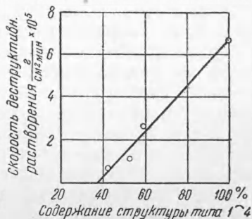
Рис. 2. Зависимость скорости деструктивного растворения вулканизованных бутадиеновых каучуков от содержания структуры типа 1-4. Температура 120°, давление кислорода 760 мм рт. ст.
