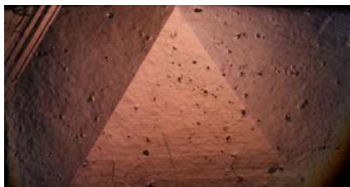
Рисунок 1 – Фрагмент монокристалла Fe_2MnGa с непараллельными соприкасающимися границами раздела аустенит/мартенсит (авторы благодарят А. Л. Созину за любезно предоставленную фотографию)
