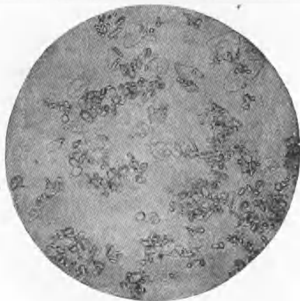
Рис. 3. Гидрат K_2SO_4 \cdot H_2O \times 60 . Репрод. 3:4
