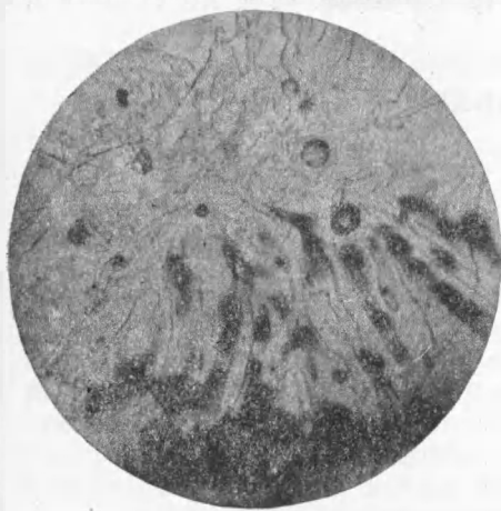
1. Проникновение бурого стекла по трещинам в чешуйчатый кристобалит. Никколи \perp . \times 80 . Репрод. 4:5
