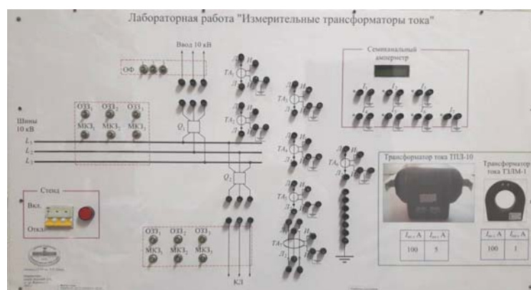
Рис. 3. Внешний вид лабораторного стенда «Измерительные трансформаторы тока в РУ 10 кВ»
