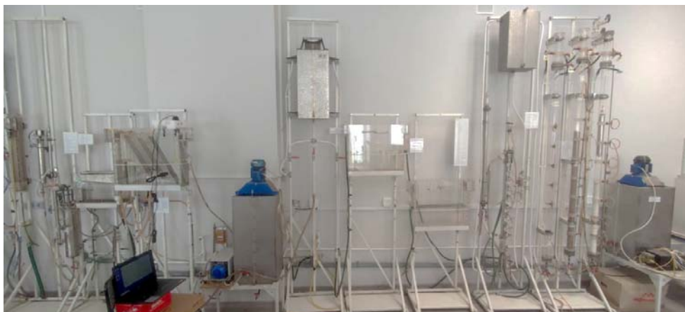
Рис. 1. Общий вид экспериментального стенда для исследования процесса отстаивания в тонкослойном отстойнике с датчиками устройства Smart Water
