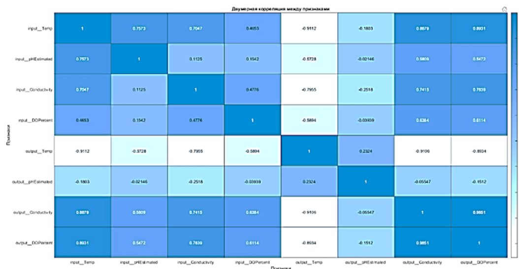
Рис. 5. Двумерная корреляция показателей качества сточных вод смешанного состава в тонкослойном отстойнике
