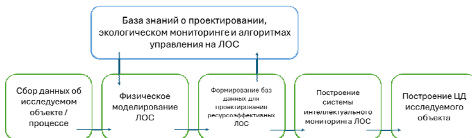
Рис. 6. Структурная схема создания цифрового двойника очистных сооружений на этапе разработки и проектирования с использованием физических моделей: ЦД – цифровой двойник
