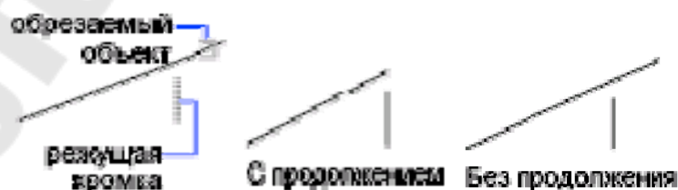
Рис. 3.210 Обрезка объекта в режиме Кромка
