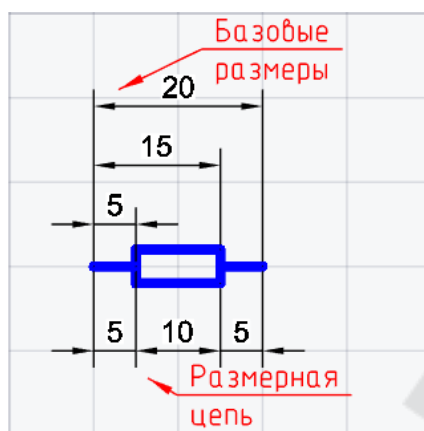
Рис. 3.92 Базовые размеры и размерная цепь
