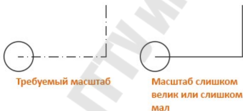
Рис. 3.143 Отображение штрихпунктирной линии в разных масштабах
