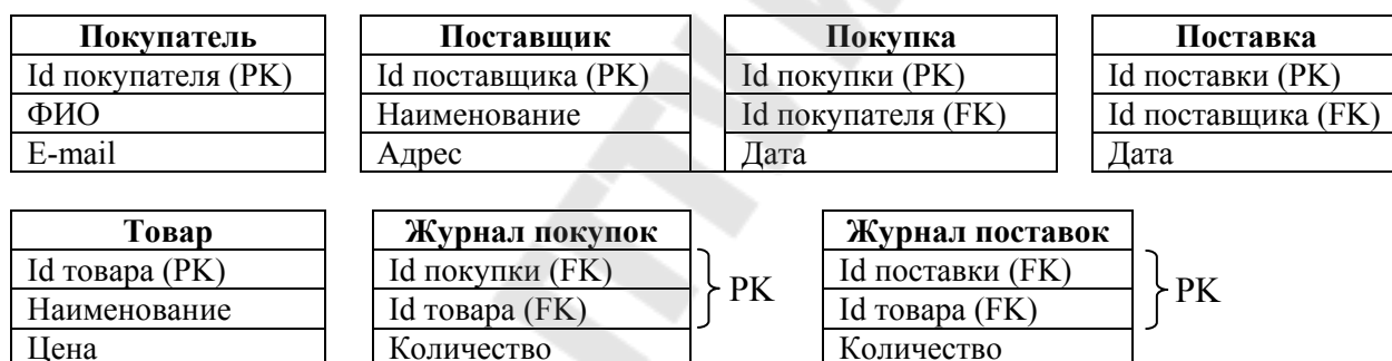
Рис. 5 – Преобразование концептуальной модели базы данных в таблицы.
