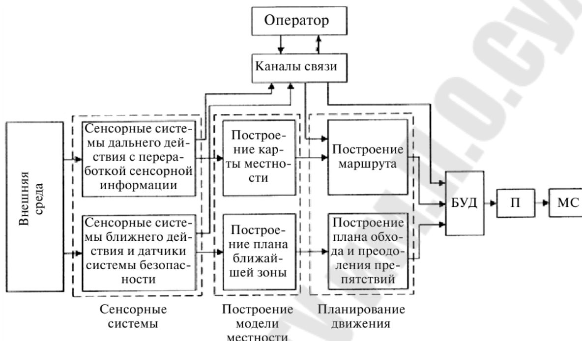
Рисунок 6.5 – Функциональная схема управления движением по местности мобильного робота: БУД – блок управления движением; П – приводы; МС – механическая система.
