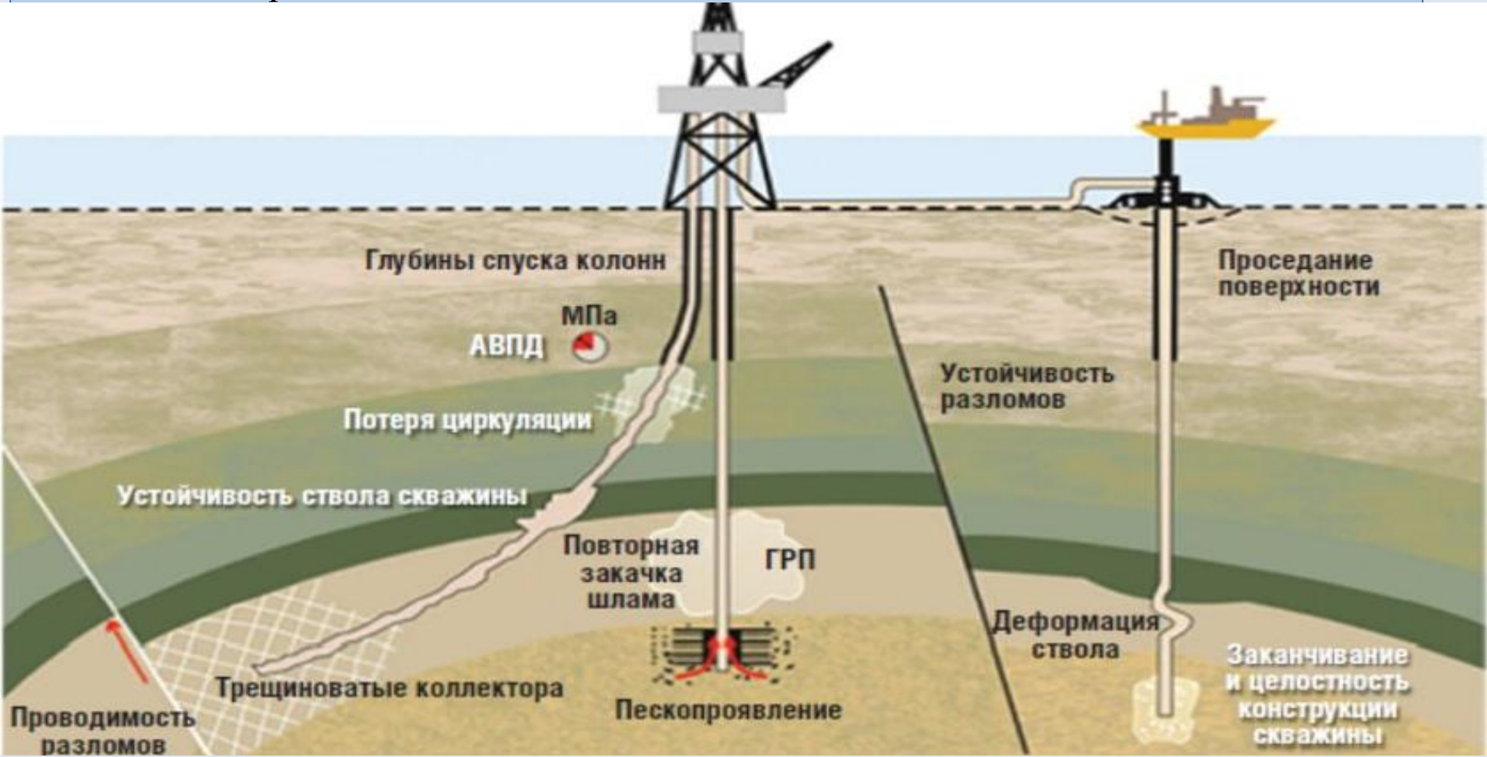
Рисунок 1 – Схема наклонно-направленных скважин
