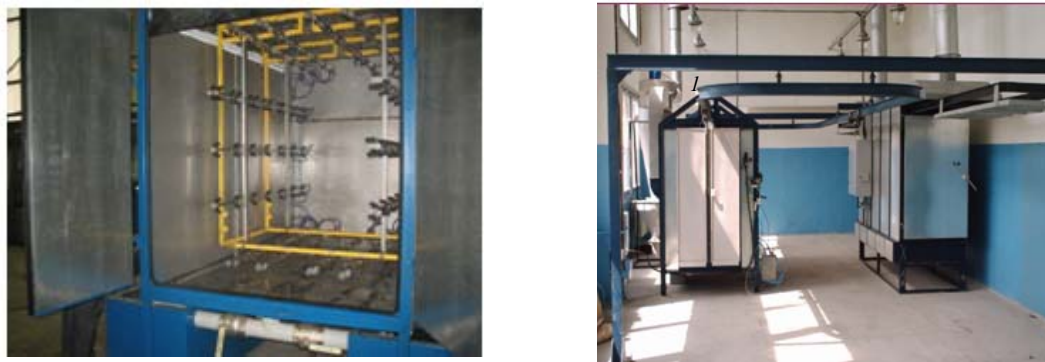
Рис. 2. Технологическое оборудование для нанесения порошковых красок на металлоизделия
