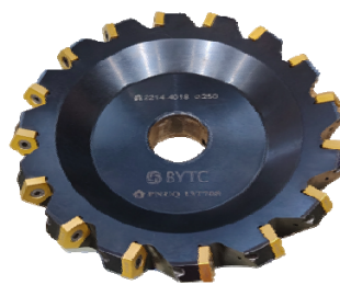
Рис. 6. Вид спеченной твердосплавной пластины PNUQ 13T709 (а), фрезы BYTC/ОИЗ для силового фрезерования (б)
