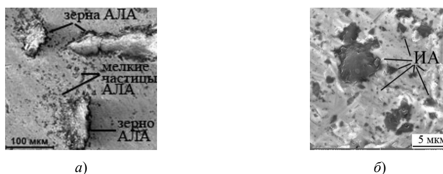
Рис. 1. Композиционный материал железо–импактный алмаз: а – микроструктура композита после ТБО; б – микроструктура гранул после МС
