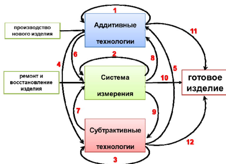
Рис. 1. Взаимосвязи между этапами технологического процесса в гибридном аддитивно-субтрактивном станке:
