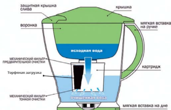
Рис. 1. Экспериментальный фильтрующий модуль на основе торфа
